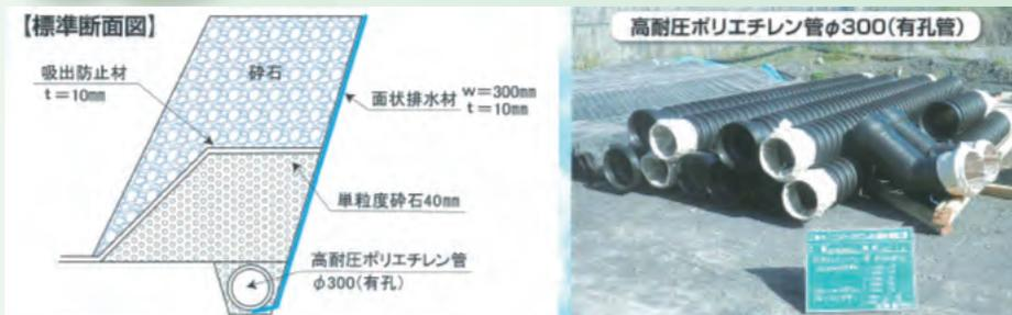
直径300mmの高耐圧ポリエチレン管を採用し、窪地内で発生する地下水・湧水が滞留しないよう、集排水をする。
