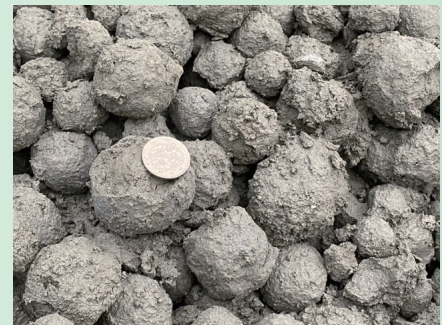
20mmオーバーの再生球状骨材 (EB)
