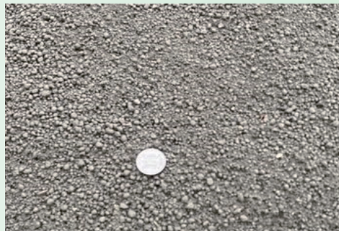
7mmアンダーの再生球状骨材 (EB)
