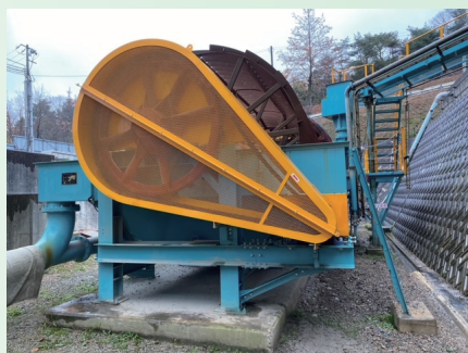
再生土を水洗いして再生砂を製造する施設。汚泥再資源化工場に併設されている。
