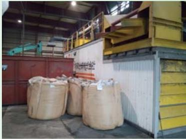
調泥後、プラント内に泥が投入され、固化材・高分子凝集剤とともに混合攪拌されます。
